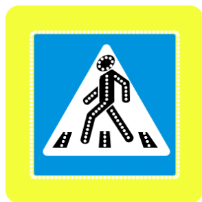
Рисунок 2.8.1 – Пример знака 5.19.1 на желтом фоне со световой индикацией
